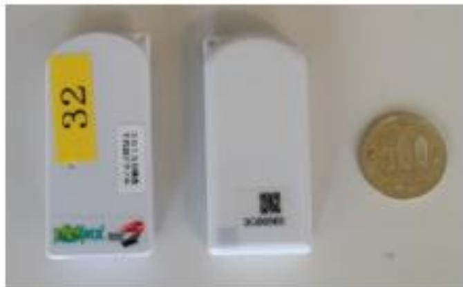
Personal D-Shuttle dosimeter – AIST; Naito et al, Rad. Prot. Dosimetry 2014
